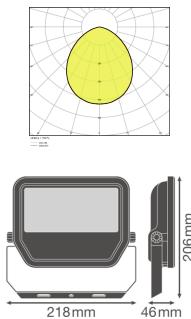
**Caractéristiques Ledvance Projecteur LED GEN 3 Blanc 50W 5500lm 100D - 830 | IP65 - Symétrique - Remplacement 100W**
