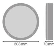
**Caractéristiques Ledvance Surface Bulkhead 300 15W 830 1400lm Noir IP65 | Éclairage de secours 3H avec détecteur**
